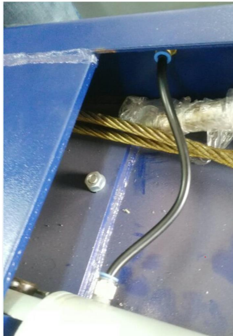
图 8.连接油缸接头和跑道接头
