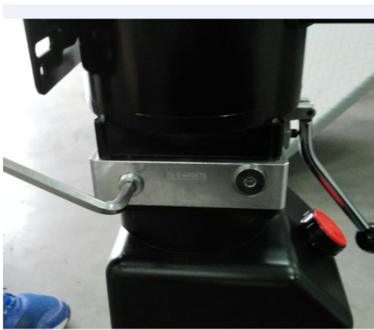
图 7.旋下堵头并安装接头
