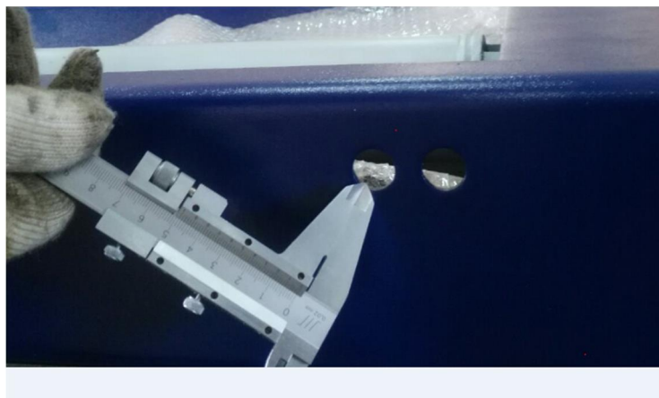
图 4.新打孔的高度
